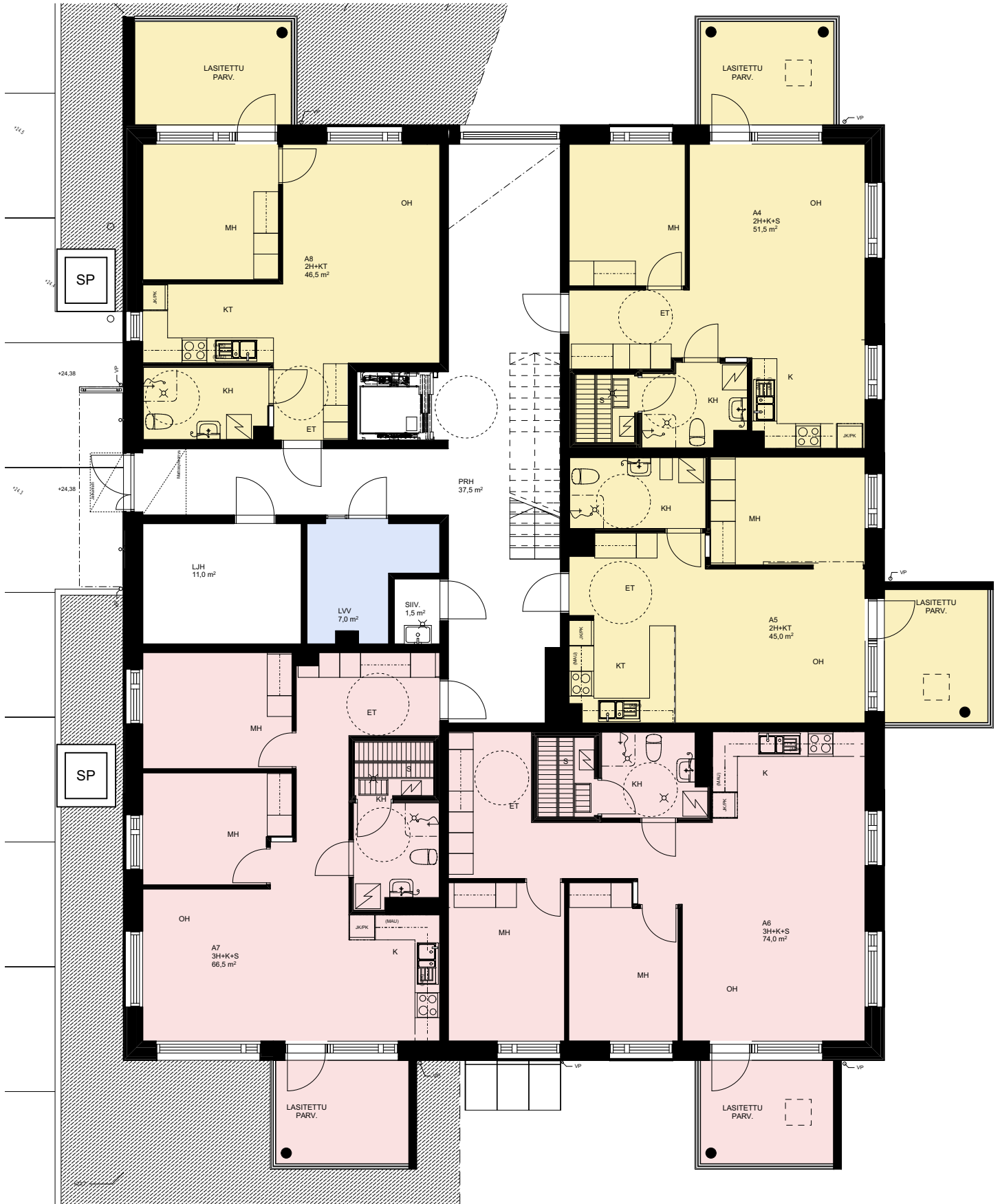
RAK1 Kerros pohja 1. kerros, 1:125 (huom. alakattoja ei ole esitetty)
